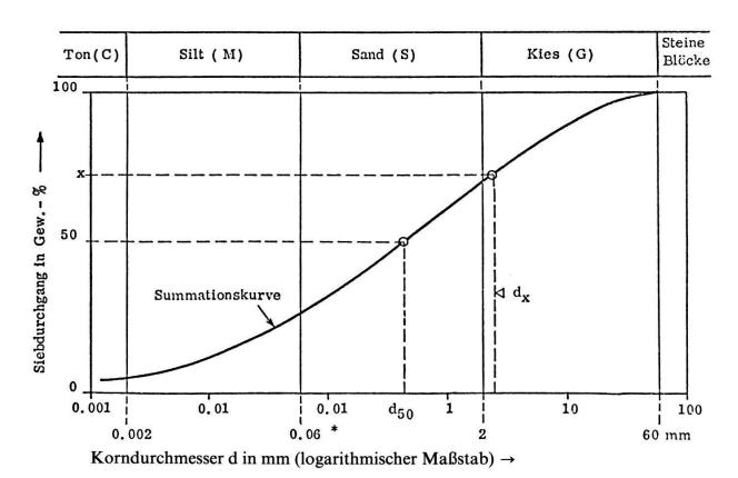
Fig. 3 Summationskurve bei Lockergesteinen
