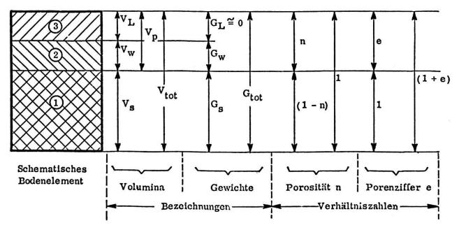
Fig. 2 Parameter bei Lockergesteinen 1 Festgesteinsvolumen  $V_s$  2 Wasservolumen  $V_w$  3 Luftvolumen  $V_L$
