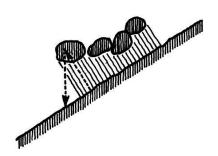
Fig. 15 Durch Quellung oder Frost werden Bodenpartikel senkrecht zur Oberfläche gehoben. Beim Schrumpfen oder Auftauen fallen sie in der Gravitationsrichtung zurück.
