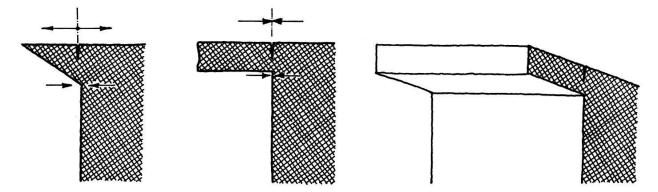
Fig. 21 Über Wand-Hängen bildet sich in resistenten Schichten oft ein Überhang aus.
