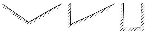
Fig. 56 Schemen von Rinnen im Querschnitt
