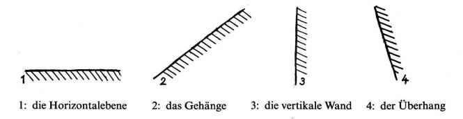
Fig. 10 Die ebene Fläche in verschiedener räumlicher Lage
