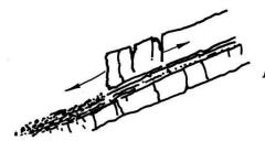
Fig. 103 Auf einem Gleithorizont fahren losgerissene Pakete ab.
