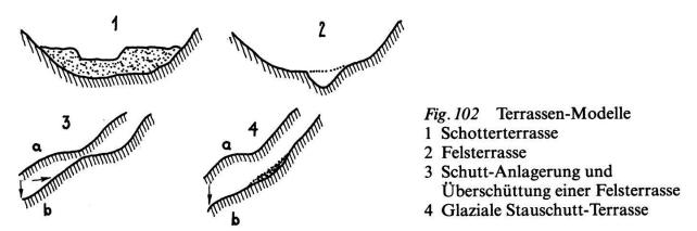
Nach der Terrassen-Theorie werden Terrassen im Anstehenden bei weiterer Eintiefung des Tales und Rückverlegung des Gehänges als Form etwa auf gleicher Höhe erhalten (Fig. 101/3). Dies trifft nur unter bestimmten Voraussetzungen, bei Härteterrassen, zu (siehe unten). Terrassen im homogenen Gestein werden allmählich ausgeglichen: durch Einschüttung von oben und Zurückwittern von unten (Fig. 101/4).
