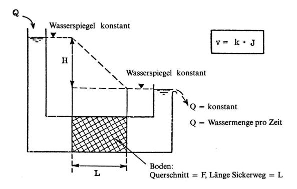
Fig. 5 Durchlässigkeitsbestimmung nach Darcy
