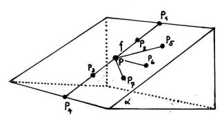
Fig. 14 Punkte im Gehänge  $(P_1-P_7)$ ;  $P_1-P_4$  liegen auf einer Fallgeraden f.  $\alpha$  = Neigungswinkel
