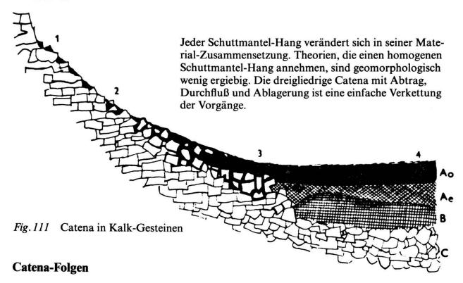
Viele Gehänge sind gestuft, weil das Innengestein verschieden resistent ist oder in der Vorgeschichte Aufschüttungen und Wieder-Einschneiden wechselten, so daß Terrassen oder Hang-Verflachungen entstanden. Auch bei Rutschungen und Sackungen bleiben oft abgleitende Massen im Gehänge stecken und erreichen den Gehänge-Fuß nicht, so daß Absätze oder Mulden entstehen.
