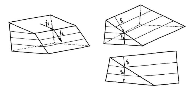
Fig. 43 Modelle von konvexen Gehängen; die Fläche f<sub>2</sub> verläuft steiler als f<sub>1</sub>.
