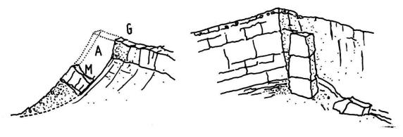
Fig. 107a) Gehänge-Verflachung durch Hinterfüllung der Sackungsmasse
