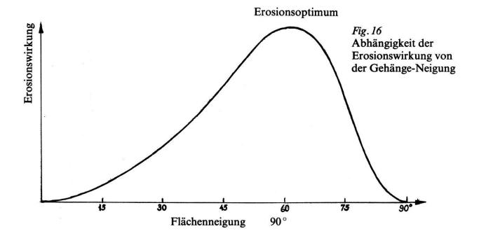
Auf der Horizontalebene fehlt die Erosion, weil die Bewegungskomponente 0 ist, in der vertikalen Wand, weil der Druck auf die Wand 0 ist. Die Erosion nimmt zunächst mit zunehmender Neigung zu, nimmt aber offensichtlich bei sehr steilem Gehänge wieder ab. Irgendwo zwischen 0 und 90° muß sich also ein Erosionsoptimum befinden, dessen Bestimmung noch der Abklärung harrt.
