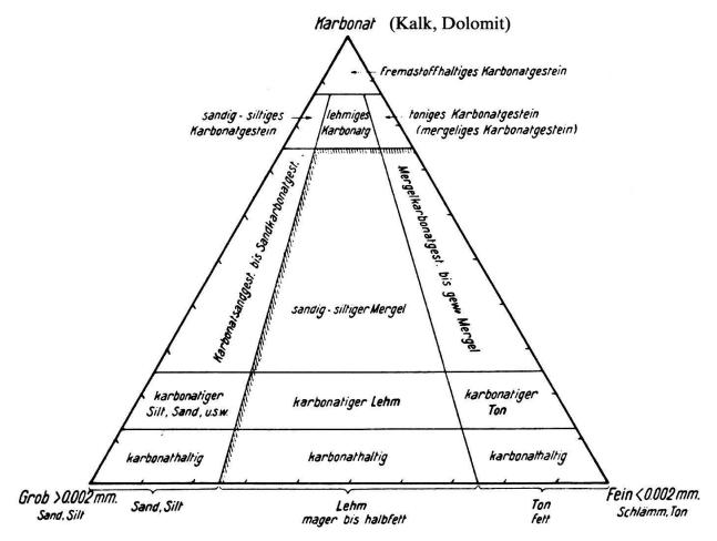
Fig. 9 Einteilungsschema von Gesteinen des Systems Sand-Silt → Schlämm-Ton → Karbonat (Kalk, Dolomit)
