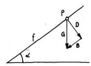
Fig. 13 Die Gehängefläche entspricht der schiefen Ebene
