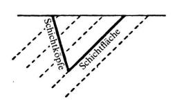
Fig. 63 Der Einfluß der Lagerung (aus O. MAULL, 1958)
