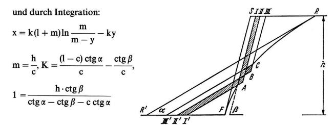
Fig. 96 Aufbau einer Schutthalde am Grunde eines Steilhanges (nach O. LEHMANN, 1933)
