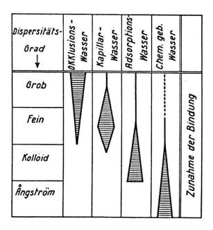
Fig. 6 Vorherrschende Wassertypen in grob-, fein-, kolloid- und ångström-dispersen Systemen (schematische Darstellung)
