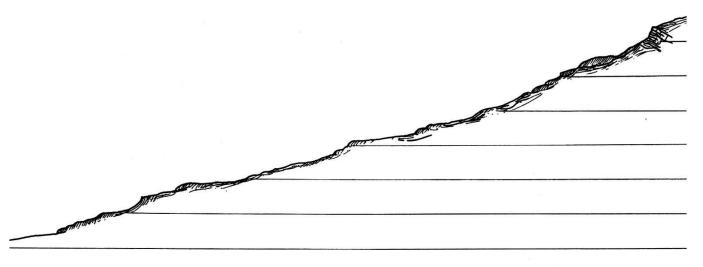
Fig. 110 Längsprofil der Gehänge-Rutschung in den Mösern, Gemeinde Schinznach-Dorf, Zustand Juni 1960. Diese Rutschung wurde über 20 Jahre vermessen (Gerber & A. E. Scheidegger, 1984)
