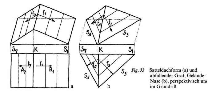
Sind die Spuren S<sub>7</sub> und S<sub>1</sub> der beiden Ebenen A<sub>7</sub> und B<sub>1</sub> parallel, so bilden konjugierte Fallinien f<sub>7</sub> und f<sub>1</sub> in der Horizontalprojektion eine Gerade. Die Kante ist eine horizontale Firstlinie. Laufen die Spuren der beiden Ebenen zusammen, bilden konjugierte Fallinien einen Winkel zwischen 0 und 90°. Die Kante, ein abfallender Grat, fällt zum Schnittpunkt der beiden Spuren ab.
