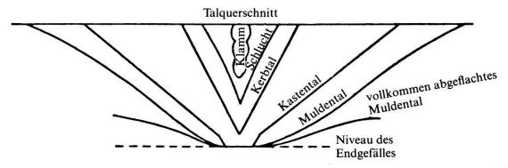
Fig. 62 Entwicklung des Talquerschnitts unter Einfluß von Höhenlage, Erosions- und Abtragungsbasis (aus O. MAULL, 1958)
