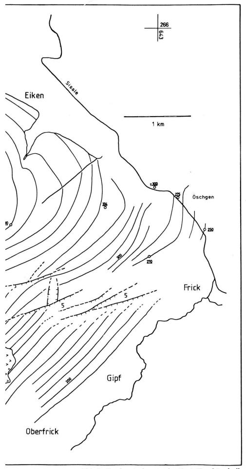
Abb. 2: Strukturisohypsen der Basis Trochitenkalk
