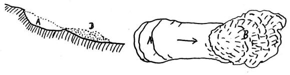
Profil Abb. 5 Zeichnung einer kleinen Gehängerutschung, A=Abrißgebiet, B=Ablagerung
