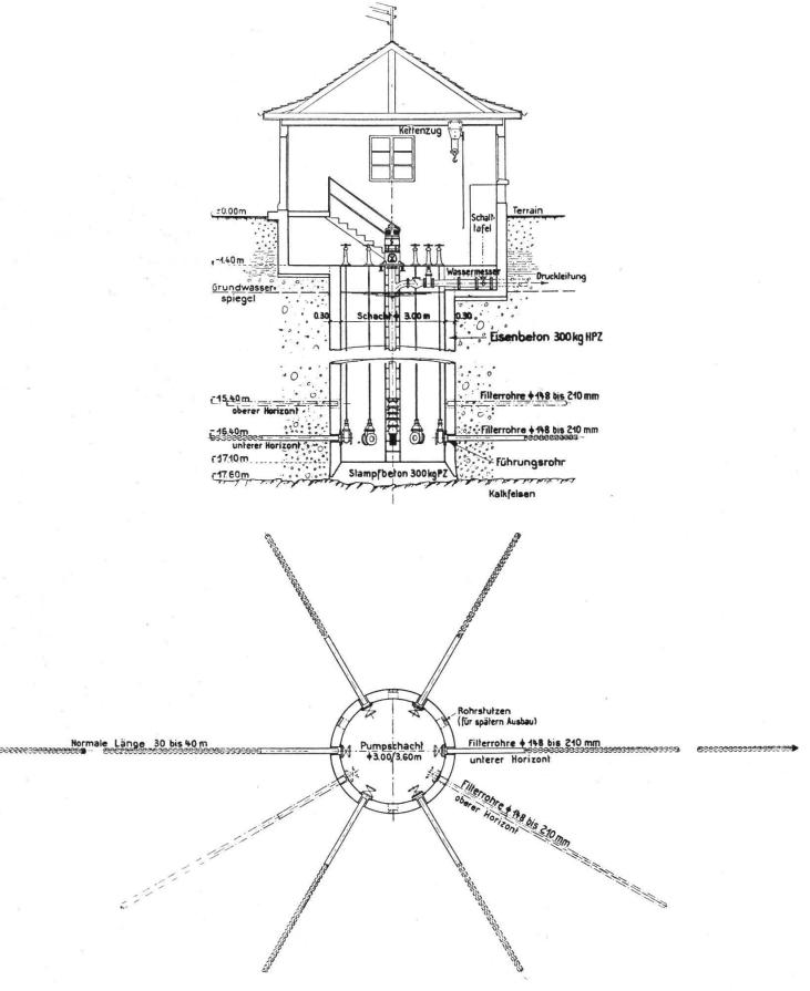
Abb. 5. Grundwasserfassung mit horizontalen Filterrohren
