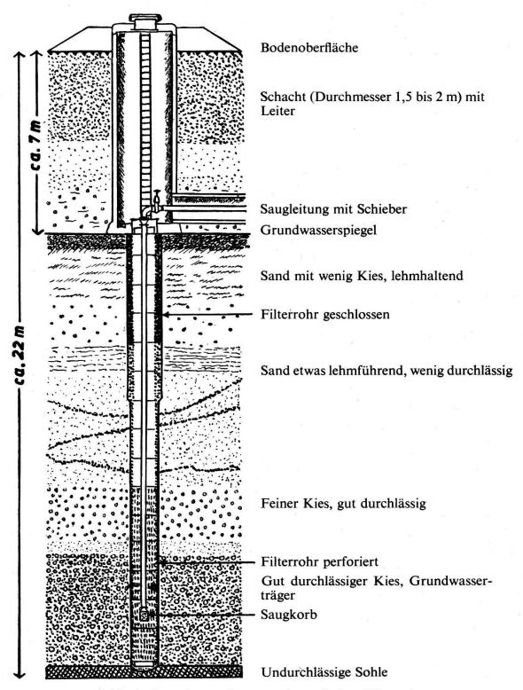
Abb. 4. Grundwasserfassung mit vertikalem Filterrohr
