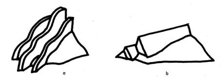
Abb. 4. Ende von Kettengliedern a bei senkrechtem Schichtverlauf, b bei steileinfallenden Schichten
