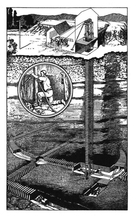
Bohnerzbergbau: Schacht mit aufgefahrenen Strecken und Erzförderung
