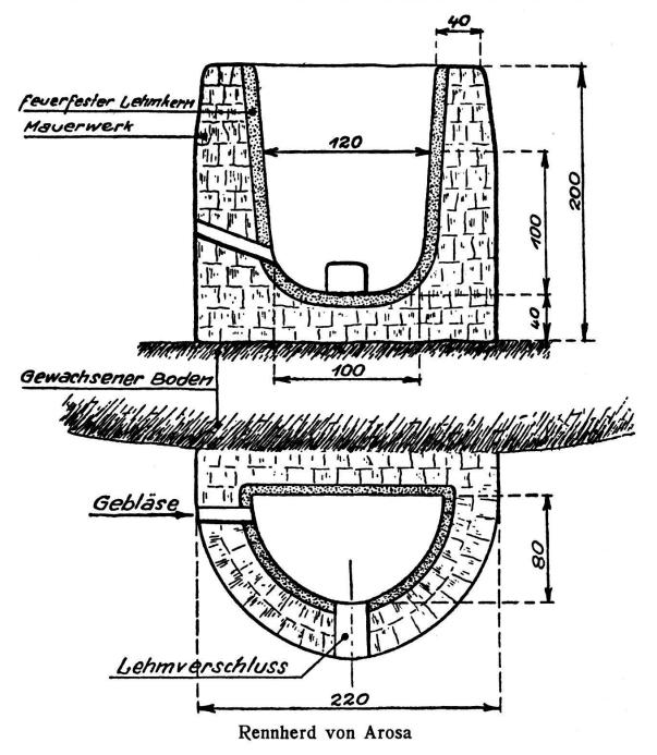
deswegen kurz mit ihrer Entwicklung befassen. Von den Römern, wahrscheinlich schon von den Kelten bis zum ausgehenden Mittelalter wurde das Eisen im Rennherd oder Rennfeuer erzeugt. Dieser Rennherd hatte eine Höhe von 2,0 bis
