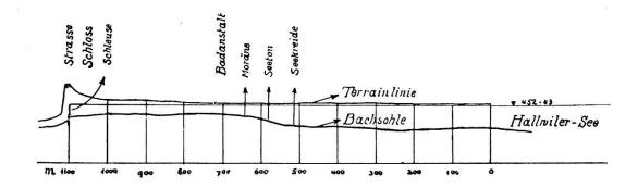
Fig. 9. Längenprofil durch den Aabach.
