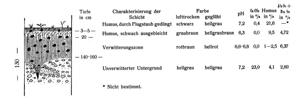
Fig. 10. Schema des Bodenprofils auf der Niederterrasse.
