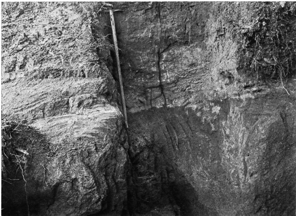
S Fig. 2. Ölsand (unten); rechts vom Pickel von unten her imprägnierte Kluft; N Schürfgrube Nr. 2, Aaretränke. Text S. 90 und 106. Phot. A. Hartmann. Reproduktion aus Beiträge zur Geologie der Schweiz. Geotechn. Serie. Lieferung VI.
