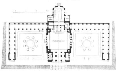
Grundriss des Krematoriums mit Urnenhallen. — Masstab 1:400.
