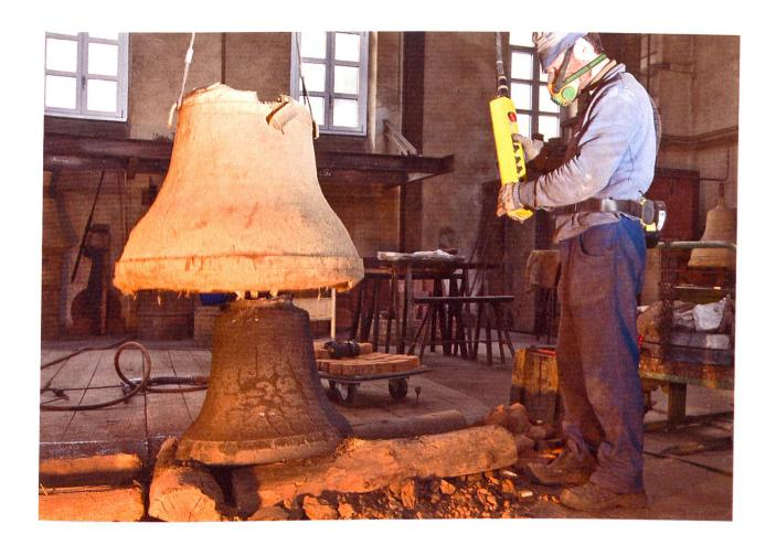
Auspacken der Glocke nach dem Guss. Zuerst wird der Backstein-Lehm-Kern der Glocke entfernt. Da in dieser Phase die Arbeit staubig und lärmig ist, trägt Markus Müller beim Ausmeisseln ein Belüftungsgerät mit Filter und Gebläse auf dem Rücken.
