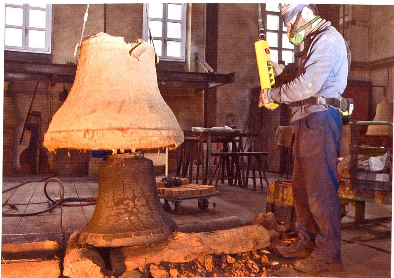
**10** Auspacken der Glocke nach dem Guss. Zuerst wird der Backstein-Lehm-Kern der Glocke entfernt. Da in dieser Phase die Arbeit staubig und lärmig ist, trägt Markus Müller beim Ausmeisseln ein Belüftungsgerät mit Filter und Gebläse auf dem Rücken.
