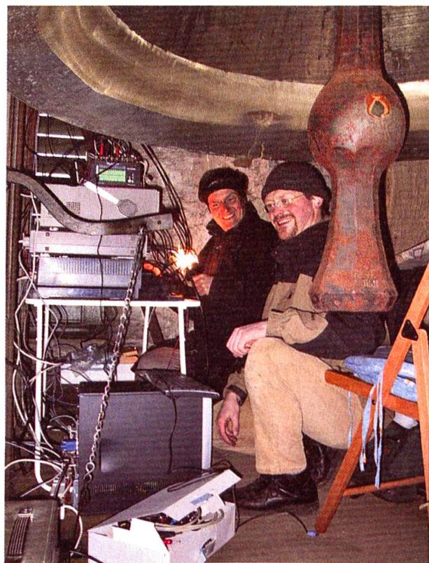
die schädlichen Einflüsse auf die Glocken akribisch erforscht und dadurch Verbesserungen in Guss, Schwingtechnik, Klöppelkonstruktion und für die Revision angestrebt. «Die Erfassung von Klöppelanschlagsintensität, Glockenbeanspruchung und des Schalls beim Läuten der vielen Glocken, ermöglicht das Erkennen der Schwachstellen.»<sup>15</sup>
