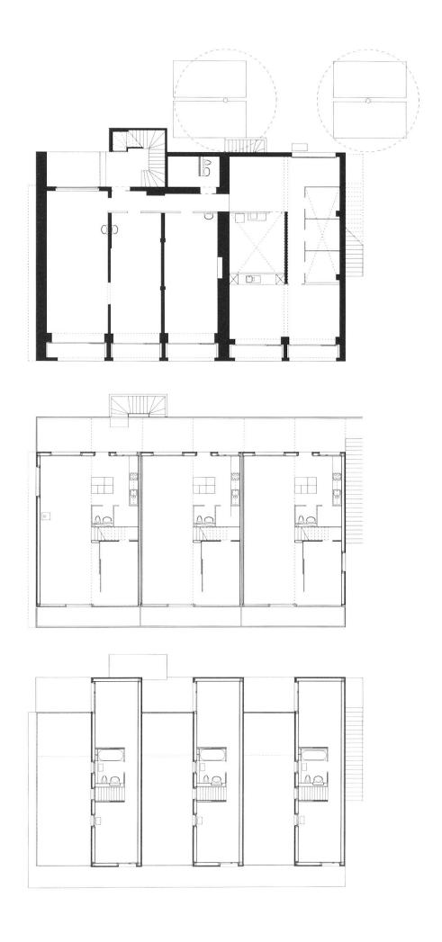
ten Oberflächen über rein gestalterische Absichten hinaus auf eine zeitgemässe Wohnlichkeit. Die grossen Verglasungen der Südfassade führen, zusammen mit dem massiven Bodenbelag, zu hohen solaren Gewinnen, während die knappe Befensterung der restlichen Fassaden die Verluste gering halten. Ein hohe Wärmedämmung und die kontrollierten Lüftungen in den Wohnungen runden die hohe ökologische Qualität des Hauses ab.
