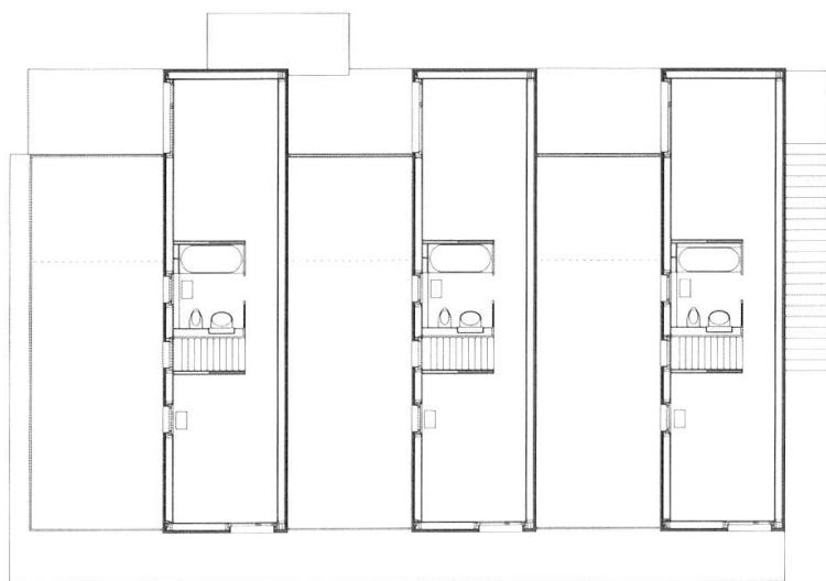
ten Oberflächen über rein gestalterische Absichten hinaus auf eine zeitgemäss Wohnlichkeit. Die grossen Verglasungen der Südfassade führen, zusammen mit dem massiven Bodenbelag, zu hohen solaren Gewinnen, während die knappe Befensterung der restlichen Fassaden die Verluste gering halten. Ein hohe Wärmedämmung und die kontrollierten Lüftungen in den Wohnungen runden die hohe ökologische Qualität des Hauses ab.
