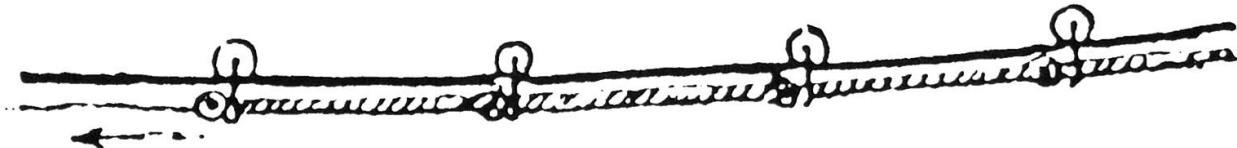
3 Zug der Ketten über die Aare. Zuerst wurde ein Drahtseil über die Aare gespannt, an jedem Gelenk der Kette wurde eine Rolle befestigt und an das Seil gehängt. Damit wurde die Kette über die Aare gezogen.
