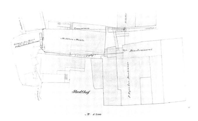
8 Kraftübertragung aus dem Hammer in die Metzgergasse. Die fast vollständige Abhängigkeit der Gewerbebetriebe vom Stadtbache zeigt dieser in die absolute Pionierzeit der Elektrifikation fallende Plan von Hammer und Ochsengäßli.
