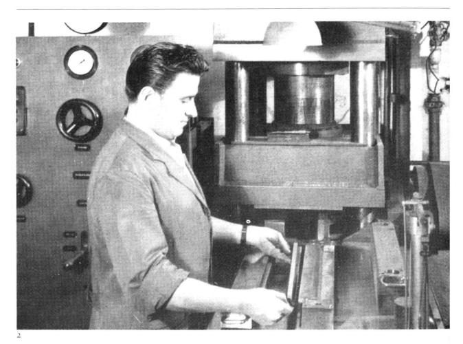
Da die Vierkantstäbe sehr zerbrechlich sind, müssen sie durch ein kurzfristiges Erhitzen bis 1200°C (Vorsintern) und in einem anschließenden Hochsinterprozeß auf 3000°C erhitzt und so verfestigt werden. Nun werden die Wolframstäbe durch mechanische Bearbeitung bei Weißglut (1600°C) in Rundhämmermaschinen Stufe um Stufe verjüngt, verlängert und duktil (streckbar) gemacht. Haben die Stäbe auf den Hämmermaschinen eine
