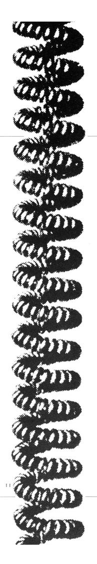
Die dünnsten Wolframdrähte haben zuletzt einen Durchmesser von etwa einem Hundertstelmillimeter und sind damit fünfmal dünner als ein Frauenhaar! Der vierkantige Wolframstab (12 × 12 mm) mußte dafür mehr als 80 Hämmer- und Ziehstufen durchlaufen, und der ursprünglich 30 cm lange Stab ist nun 100 km lang geworden!
