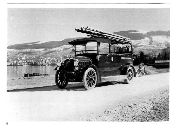
«Saurer» - Automobil - Feuerlöschspritze mit «Sulzer» - Feuerlöschpumpe. Als erste Feuerwehr im Kanton wurde Aarau motorisiert. Die aargauische Baudirektion hatte eine Anleitung zur Anschaffung von Automobilspritzen erlassen. Die geforderten Leistungen an die Spritze waren sehr hoch: es mußten bis zu 1500 Liter Wasser in der Minute auf 230 m Entfernung mit 3 Atmosphären Druck in die Strahlrohre gepreßt werden können. Nach weitreichenden Abklä-
