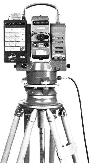
Der elektronische Kern-Theodolit mit Datenspeicher und elektrooptischem Distanzmessgerät, wichtigstes Glied in einem automatischen Vermessungssystem.
