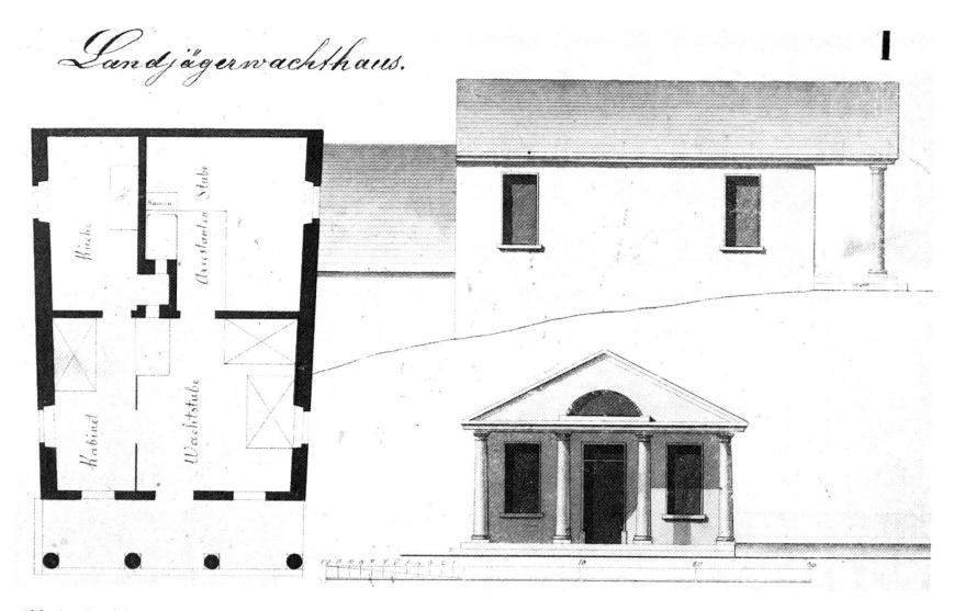
Abb. 1 Projektplan von 1821 für das Landjägerwachthaus am Holzmarkt. Das markante Architekturmotiv der Säulenfront ist hier im kleinsten Massstab angewandt. Aarau, Archiv Stadtbauamt
