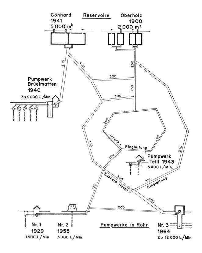
Abb. 5. Die Aarauer Wasserversorgung im Jahr 1965; Schema. Unterbrochene Linien: Projektiert bzw. im Bau.
