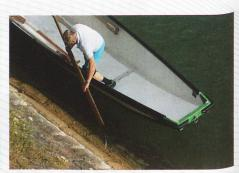
Zum Wasserfahren braucht es Kraft, aber vor allem auch eine ausgefeilte Technik. Einsatz des Stachels, um mit dem Weidling flussaufwärts zu fahren.
