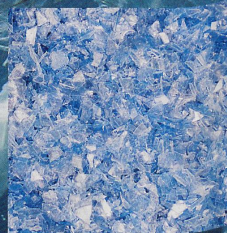
Aus alten Plastikflaschen wird neues Plastikgranulat
