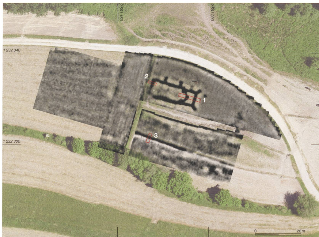
4 Court, Mévilier. Visualisation des résultats de la prospection géoélectrique de 2024 : le plan de deux églises successives avec agrandissement du chœur se dessine parfaitement. 1-3 Sondages de contrôle. Éch. 1:1000.
