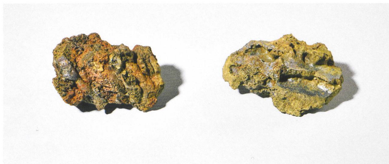
84 Wiedlisbach, Städtli 29. Fayalitische Kalottenschlacken, Typ 5 (SGD). Links mit Fließstrukturen, rechts typisches Aussehen einer fayalitischen Schlacke. M. 1:3.
