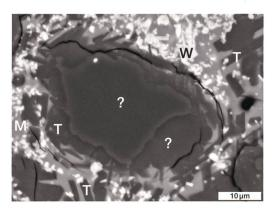
7 Bern, Brunngasshalde. Image au MEB-MER de l'échantillon BER 19 à travers un grain 100 % poids d'oxyde de silicium (SiO<sub>2</sub>). Le cœur central (quartz?) présente des contours irréguliers, ce qui indique une forte fusion lors du frittage. Il est entouré par des baguettes de tridymite (T). On trouve la tridymite avec la wollastonite (W, cristaux blancs) aussi dans la matrice vitreuse (M).
