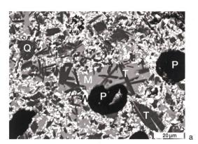
6 Bern, Brunngasshalde. Images au MEB-MER de l'échantillon BER 19 à travers le corps céramique non lessivé (a) et lessivé (b): M matrice vitreuse ou verre; P pore; Q quartz; T tridymite; W wollastonite. Les petits trous noirs de l'image (b) ont été créés par le lessivage des wollastonites lors de l'enfouissement
