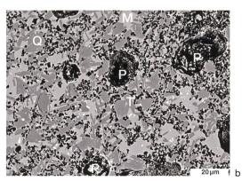
(4) une matrice vitreuse de couleur gris clair. De plus, il y a encore de gros pores (diamètre max. 23  $\mu$ m) aux contours irréguliers et de couleur noire (fig. 6a et b).
