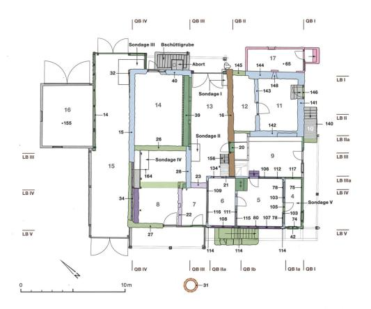
8 Thun, Schorenstrasse 40. Grundriss des Erdgeschosses mit Bauphasen, Bundachsen (Längsbund: LB; Querbund: QB) und Raumnummern. M. 1:250.
