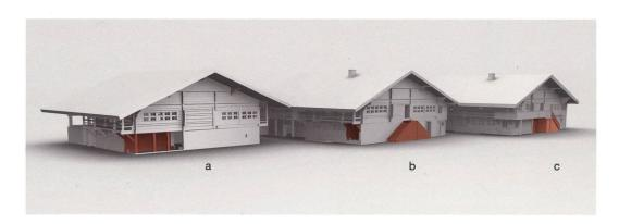
28 Thun, Schorenstrasse 40. Drei schematische Hausmodelle verdeutlichen den Wandel der Hauseingänge (rot): a um 1600 (Phase 3) mit rein traufseitiger Erschliessung, b um die Mitte des 18. Jahrhunderts (Phase 5) mit trauf- und giebelseitiger Erschliessung; c ab der ersten Hälfte des 20. Jahrhunderts (Phase 9) mit rein giebelseitiger Erschliessung.
