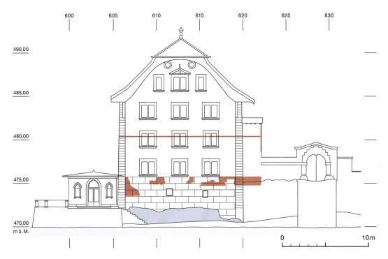
3 Utzenstorf, Schloss Landshut. Ostfassade. Rot: Mauerwerk der Phase 2 (s. Abb. 3) mit horizontal verlaufendem Absatz auf Höhe des ersten Obergeschosses. Blick nach Westen. M.1:300.
