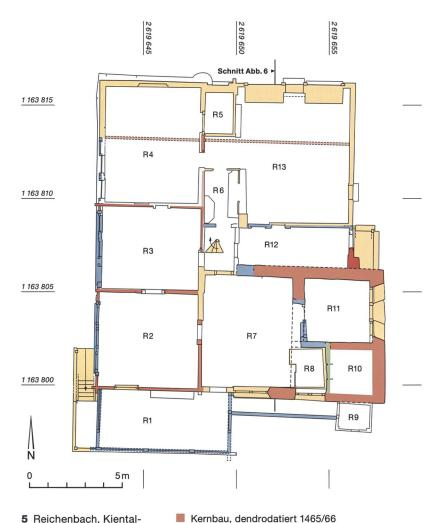
5 Reichenbach, Kientalstrasse 12. Grundriss des Stubengeschosses. Rot: Im Südosten kragt der steinerne Teil (R7, R10, R11) vor. Westseitig liegen die beiden Stuben R2, R3 und ein weiterer Raum R4; grün: Raum R10 wird zum Backofen eingekürzt; blau: Erneuerung der Fassadenhölzer im Westen und Einbau eines Raumes R12 im Nordosten. Südseitig wird die Laube R1 angehängt; gelb: Norderweiterung und Einbau des Ladens. M. 1:200.
