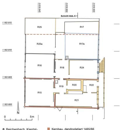
8 Reichenbach, Kientalstrasse 12. Grundriss des Gadengeschosses. Rot: Der Bau von 1466 verfügte über einen Gaden R15 im Südwesten und die offene Rauchküche R7; grau: um 1695/96 Einbau des Gadens R16: blau: im 18./19. Jahrhundert Einbau der Räume R24, R17a und R25a; gelb: Verschluss der offenen Rauchküche im 20. Jahrhundert und Umnutzung der Kammern R17a und R25a zu den Abstellräumen R17 und R25. M. 1:200.
