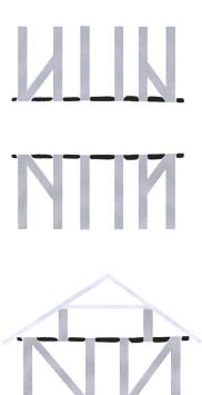
12 Mörigen, Uferzone. Rekonstruktionsvorschläge für die Verwendung des Balkens als Schwellbalken (oben) oder Rähmbalken (Mitte und unten). M. 1:100.
