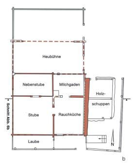
4 Grundrisse der Stubengeschosse. a Frutigen, Innerschwandiweg 14; b Kandergrund, Ausserrüteni 121. Beide Grundrisse sind sehr ähnlich. Rot: originale Bausubstanz; rot gestrichelt: originale Lage, Bausubstanz erneuert; grün: Erweiterung 20. Jahrhundert. M. 1:200.
