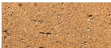
Abb. 3a: Scherbenquerschnitte, zusammen- gefasst für die Proben aus Bern (Ofe 39, 52, 53, 67–71) und Nidau (Ofe 43, 44, 47). Untere Kante des Querschnittes jeweils 2,5 cm breit.
