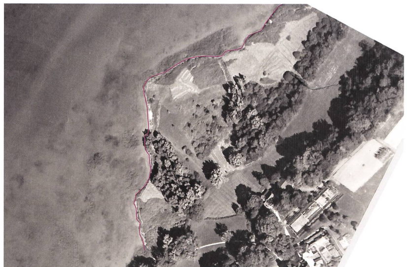
Abb. 3: Sutz-Lattrigen, Rütte. Die Uferlinie im Bereich der Fundstelle von 1947 (oben), projiziert auf ein Orthofoto vom Mai 2014 (unten). Der Uferrückgang an der Landspitze betrug rund einen halben Meter pro Jahr.
