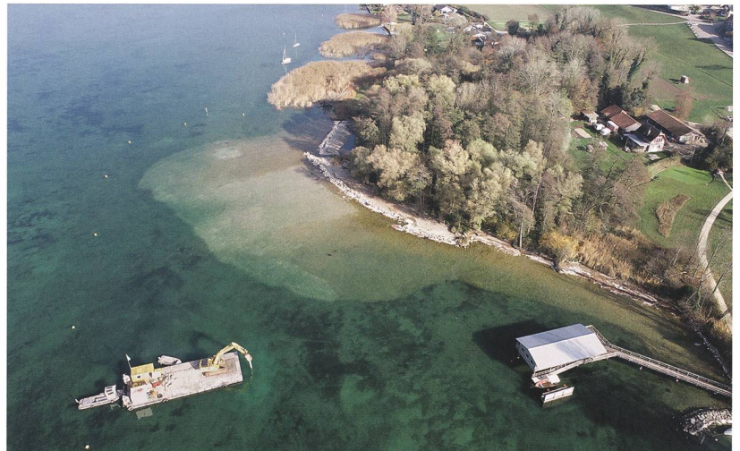
Abb. 6: Der Wellenbrecher schützt das Ufer vor der Erosion. Die Hinterfüllung aus Kies wird bei hohem Wasserstand überflutet. Aufnahme 19. April 2021.
