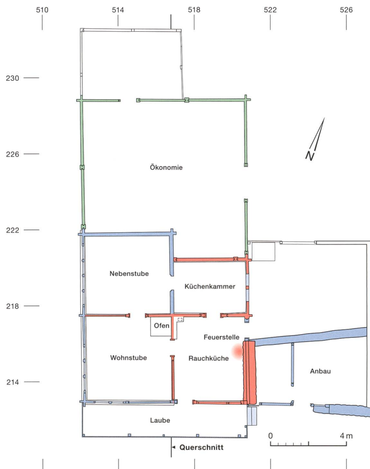
Abb. 4: Aeschi b. Spiez, Suldhaltenstrasse 31. Grundrissplan zum Erdgeschoss. Gut zu erkennen ist die 1779 vergrösserte Nebenstube, die nach Norden in die Ökonomie vorspringt. M. 1:200.
