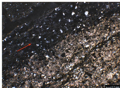
Abb. 42: Oberbipp, Steingasse. Mikrofoto der Schicht 127.1, selber Ausschnitt wie Abb. 41, XPL. Das Schieferplättchen zeigt infolge Bodeneinlagerung einen kalkfreien Verwitterungssaum (Pfeil).
