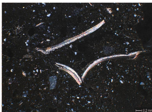
Abb. 38 (links): Oberbipp, Steingasse. Mikrofoto des Bauniveaus 127 mit Fragment eines Gneises, wie er in den Dolmensteinen vorkommt. XPL.
