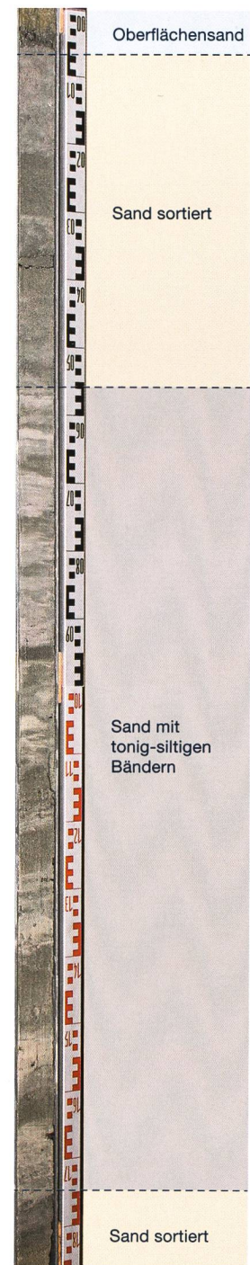
Abb. 4: Vinelz, Seewil. In den Bohrkernen zeichnen sich vor allem Schichten mit hohen Sandanteilen ab.
