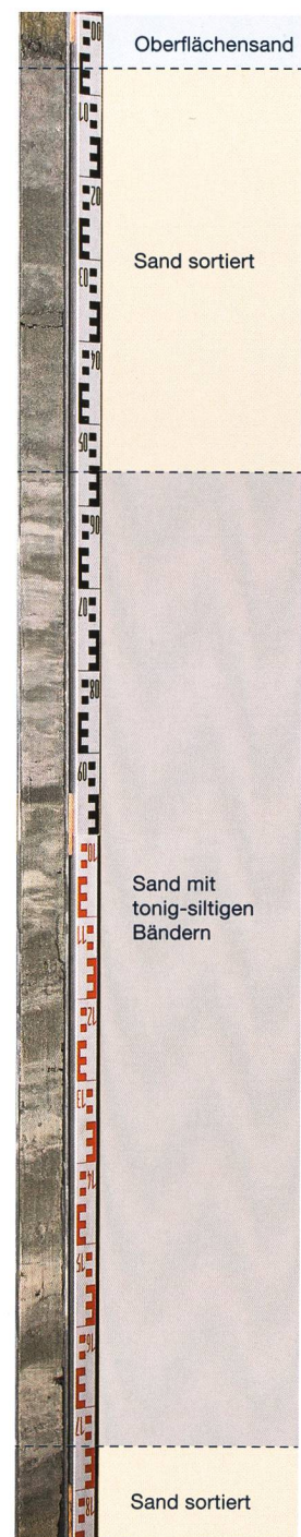
Abb. 4: Vinelz, Seewil. In den Bohrkernen zeichnen sich vor allem Schichten mit hohen Sandanteilen ab.
