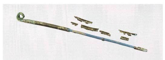
Fig. 5: Kehrsatz, Breitenacher. Emplacements des mesures PXRF: sur la tête corrodée de l'épingle (A) et sur la tige (B). Éch. 1:3.
