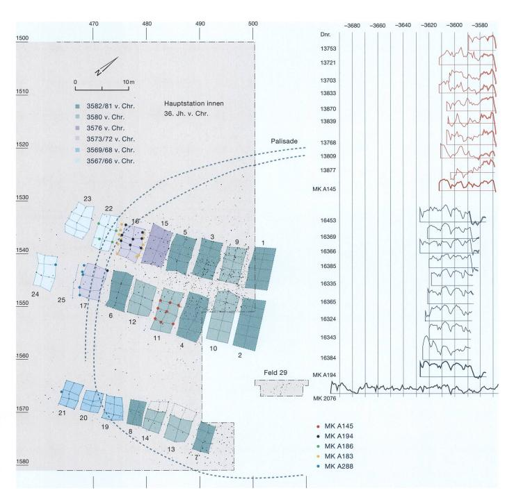
Abb. 16: Sutz-Lattrigen, Hauptstation innen. Links: die Pfähle einer MK-Gruppe wurden oft im gleichen Haus verbaut; rechts: Die Wachstumskurven der Pfähle jeweils einer MK-Gruppe verlaufen sehr ähnlich. Abgebildet sind die Wuchsbilder der Gruppen MK A145 und MK A194. M. 1:500.
