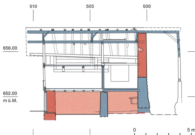
Abb. 20: Stocken-Höfen, Stockentalstrasse 33. Südlicher Längsschnitt durch das Wohngebäude und den angrenzenden Tenn auf Höhe des Firstes (rot: Kapellenmauern erhalten; hellrot: Wandflächen; blau: Mauern und Hölzer des ältesten Wohnhauses; weiss: jüngere Befunde). Für die Lage des Profils s. auch Abb. 11. M. 1:200.
