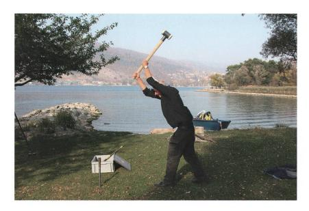
Abb. 4: Ipsach, Erlewäldli. Einschlagen des Bohrgestänges zur Abklärung der Schichterhaltung.
