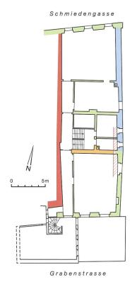
Abb. 2: Burgdorf, Schmiedengasse 1. Ansicht der ehemaligen Südfassade (heute Binnenmauer). Rot: die beiden ältesten Mauern um 1200 (rechts: Stadtmauer; links: Ostfassade Schmiedengasse 3); orange: die ehemalige Südfassade nach 1200; grün: der Neubau nach dem Stadtbrand von 1706. M. 1:100.
