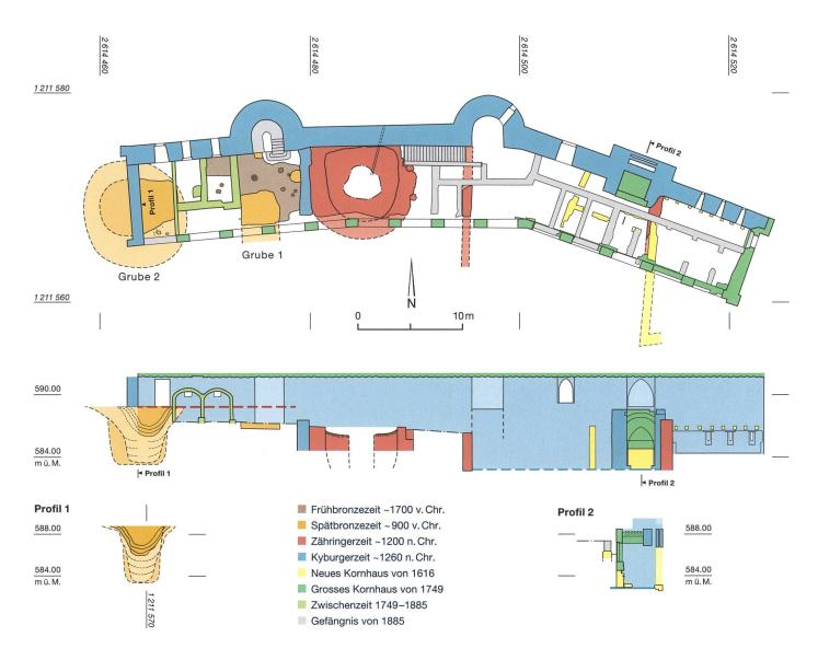
Abb. 2: Burgdorf Schloss. Ausschnitt des nördlichen Bereichs des Schlosses. Grundriss und Schnitt der untersuchten Fläche sowie Maueransichten im Bereich des Grossen Kornhauses mit den verschiedenen Bauphasen. M.1:400.
