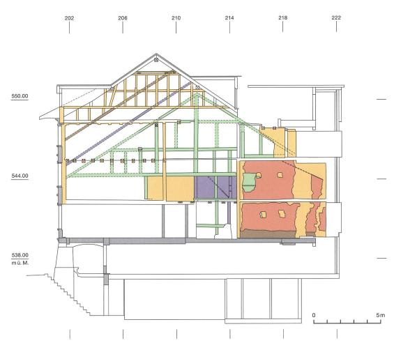
Abb. 5: Bern, Rathausgasse 64. Westbrandmauer im Dachgeschoss mit den eingemauerten Rafen der verschiedenen Dacherhöhungen, darüber die Aufstockung zum heutigen Dach. Blick nach Westen.
