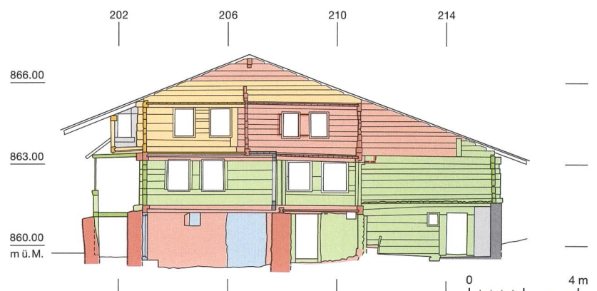
Abb. 3: Aeschi, Suldhaltenstrasse 8. Querschnitt durch das Gebäude. Rot: Grundkonstruktion; orange: jüngerer Umbau oder zweiter Bauholzbestand; blau: diverse Zumauerungen; grün: Umbau (19. Jh.); grau: jüngste Umbauten mit Zement. Blick nach Südwesten. M. 1:200.
