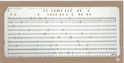
Abb. 7: Für die ersten dendrochronologischen Untersuchungen der Hölzer von Twann wurden die Messungen der Jahrringbreiten der Hölzer auf Lochstreifen (7a) erfasst, auf Lochkarten (7b) übertragen und von einem Techniker in den Hauptcomputer der Universität Köln eingespiesen.
