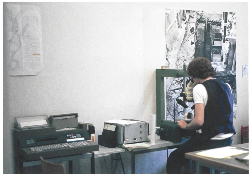
Abb. 8: Arbeiten im Dendrolabor Zürich im Jahr 1978. Revolutionär für die Arbeiten war, dass dank der neuen Geräte die am Messstisch unter dem Mikroskop erfassten Jahrringbreiten (rechts) über ein Interface (Mitte) direkt an den Olivetti P6060 Mini-Computer (links) geleitet wurden. Dieser stellte die Messungen in Kurven dar, welche auf Thermopapier ausgedruckt werden konnten.
