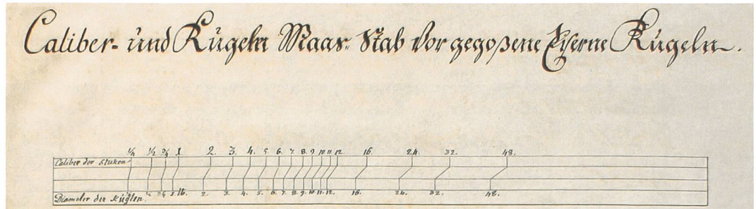
Abb. 4: Der 1760 von Hauptmann Müssli gezeichnete Massstab listet in der oberen Zeile das gesamte Spektrum der bernischen Stückkaliber von Falkonetten über Kanonen bis hin zu grossen Haubitzen auf. In der unteren Zeile können die Geschosskaliber zwischen \frac{1}{4} lb und 48 lb abgemessen werden.
