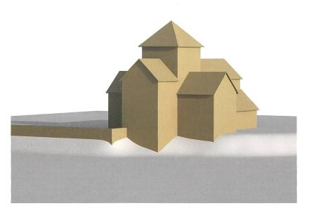
Abb. 23: Krauchthal, Hettiswil, Oele 1–3. Rekonstruktionsvorschlag zur mittelalterlichen Prioratskirche mit gerade geschlossenem Altarhaus, ausladendem Querhaus ohne Apsiden, Vierungsturm und basilikalem Langhaus.
