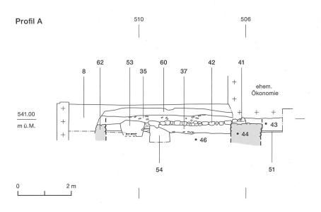
Abb. 19: Krauchthal, Hettiswil, Oele 1–3. Südwestprofil A der Fläche 4 der Grabung 2004. Schnitt durch den Vierungsbereich der Kirche mit Pflasterung und zwei Gräbern. M. 1:100.
