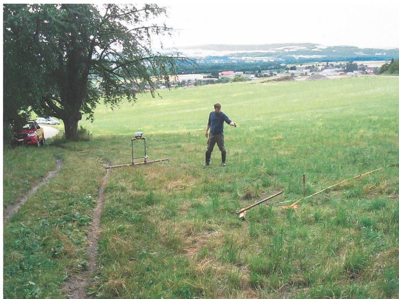
Abb. 4: Studen-Petinesca, Ried 2017. Geoelektrische Messungen durch Manuel Buess. Die Wiese wird im Hintergrund durch den Rand der Deponie begrenzt. Angrenzend ist sie auf einer Breite von rund 50 m rekultivierte Auffüllung. Blick nach Südosten.
