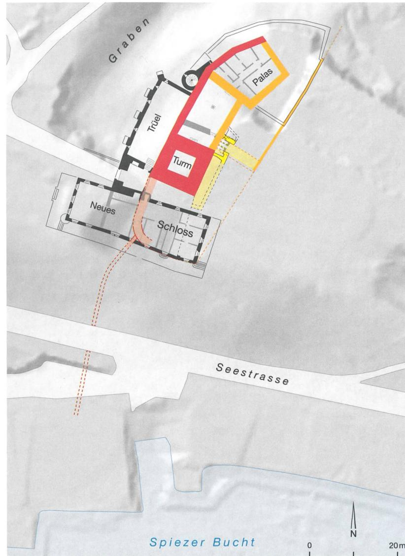
Abb. 4: Spiez, Neues Schloss. Grundriss mit der topografischen Lage des Schlosses. Bauphase rot um 1200; Bauphase orange gehört ins 13. Jahrhundert; Bauphase gelb stammt aus dem Übergang vom 15. ins 16. Jahrhundert.
