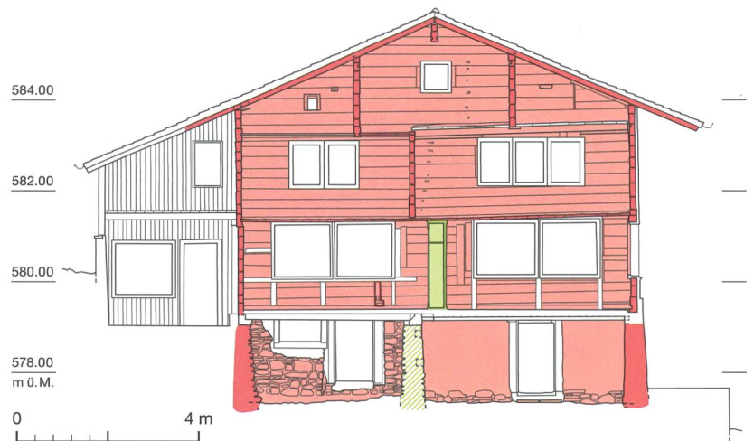
Abb. 5: Oberried, Untergasse 9. Schnitt durch die ostseitigen Räume. Rot eingefärbt ist der ursprüngliche Bau. Grün schraffiert ist die eventuell versetzte Binnenmauer und in grün gehalten ist der in die Binnenwand integrierte Wandschrank. In Weiss sind die jüngsten baulichen Veränderungen gehalten. Blick nach Osten. M. 1:150.
