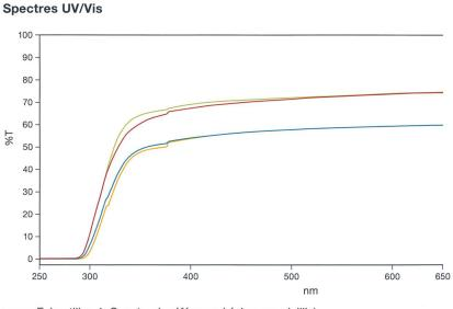
Echantillon 1 Spectre de référence (résine non vieillie) Echantillon 2 Biorésine exposée à la lumière directe
