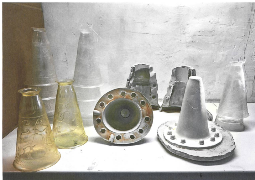
Fig. 3: Bienne, église de Mâche. Tirages en biorésine au fond et en résine époxy au premier plan.
